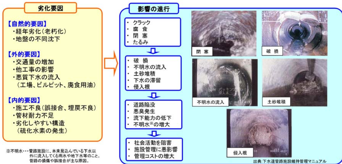
図 3-2-43. 下水道施設の劣化要因 (管路施設)
